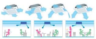
ОБЕСПЕЧИВАЮТ ПРИТОК СВЕЖЕГО ВОЗДУХА. Несмотря на компактные размеры, через специальную раму (опция), кондиционеры FDTC-VF позволя-
